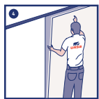
Bevestig een gipsplaat op de profielen/balken om de wand af te werken.
