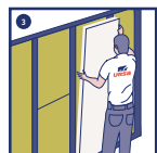
Bevestig een gipsplaat op de profielen/balken om de wand af te werken.
